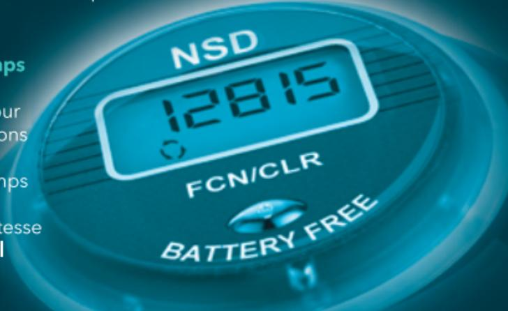
\* Note: l'écran LCD est alimenté par induction et ne fonctionne que lorsque le rotor dépasse 1.800 tours par minute.
