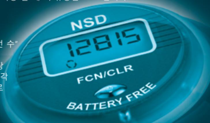
\*LCD 디스플레이는 로터의 자가발전으로 작동되며, 오직 로터의 속도가 1800 RPM 이상의 속도에서 작동합니다.
